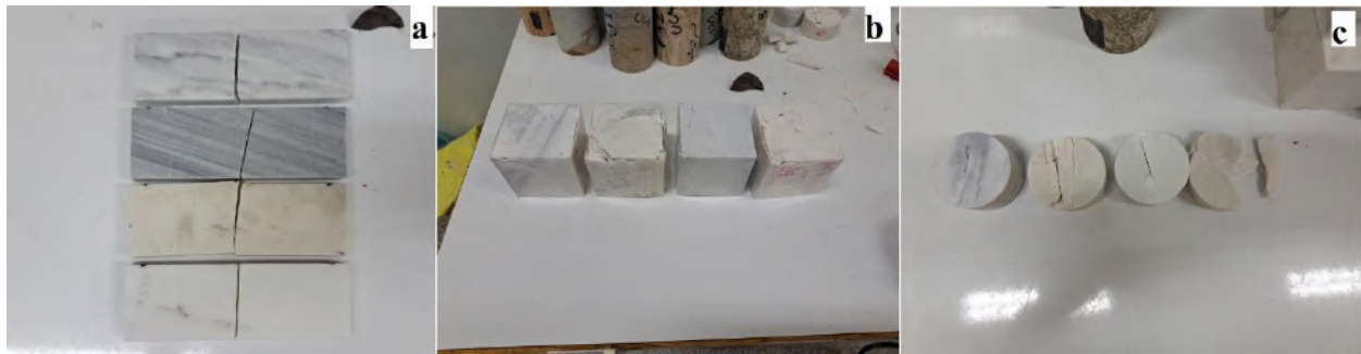
شکل ۲ تصاویر نمونه‌های شکسته شده در آزمون‌های تعیین ویژگی‌های مقاومتی؛ (a) آزمایش مقاومت خمشی، (b) آزمایش مقاومت فشار تک محوری (c) آزمایش کشش غیرمستقیم.
