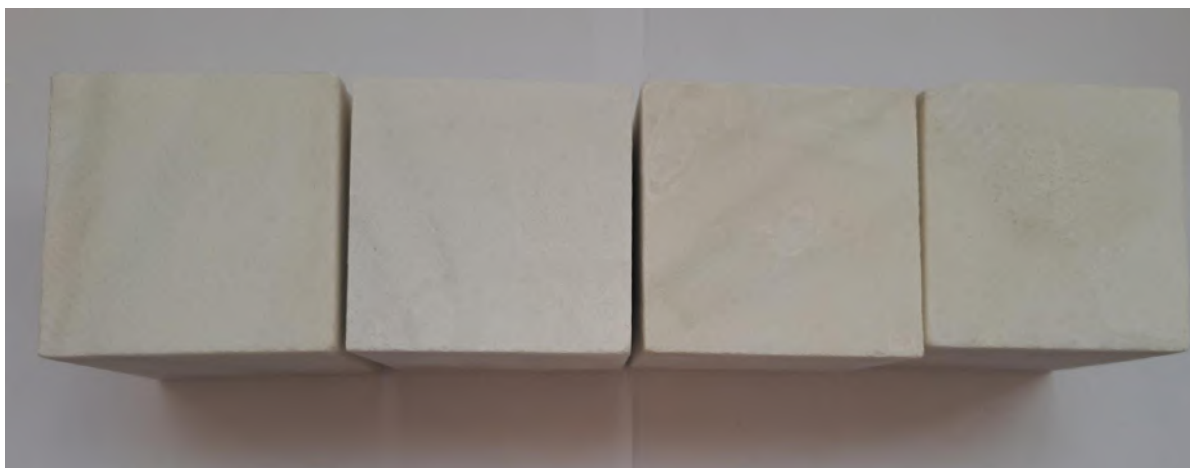
شکل ۸ ظاهر نمونه بعد از ۳۰ چرخه آزمایش تر-خشک شدن در اسید
