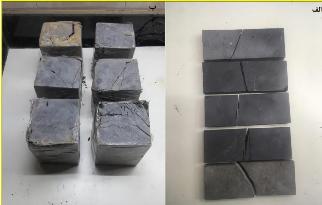
شکل ۳ اندازه گیری مقاومت خمشی برای سنگ مرمریت سیاه تم
