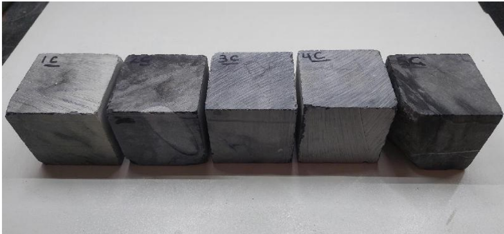
شکل ۱۴ تغییر در ظاهر نمونه پس از آزمایش در فرایندهای ترکیبی پس از ۲۰ چرخه
