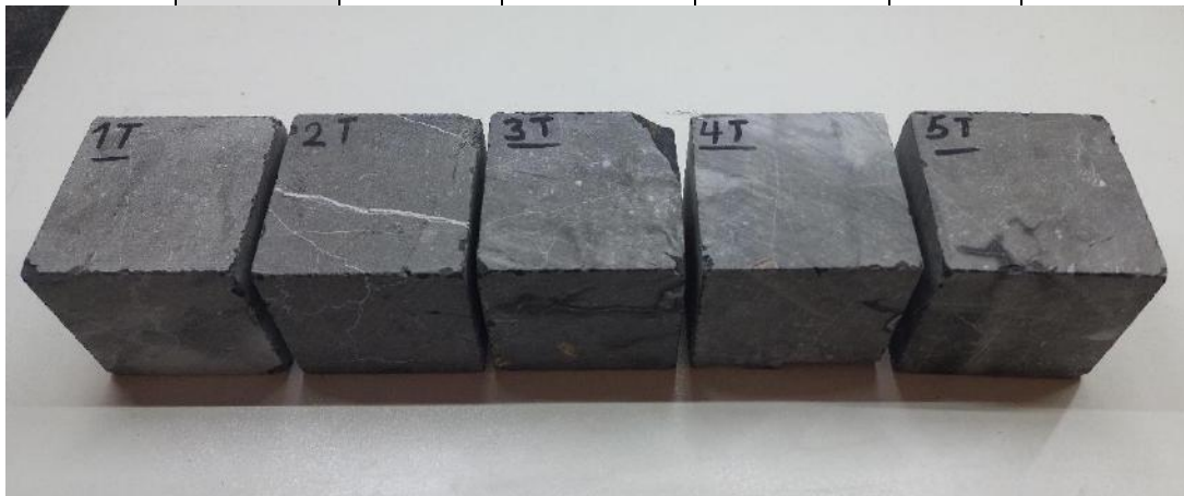
شکل ۱۳ تغییر در ظاهر نمونه پس از آزمایش شوک حرارتی پس از ۲۰ چرخه
