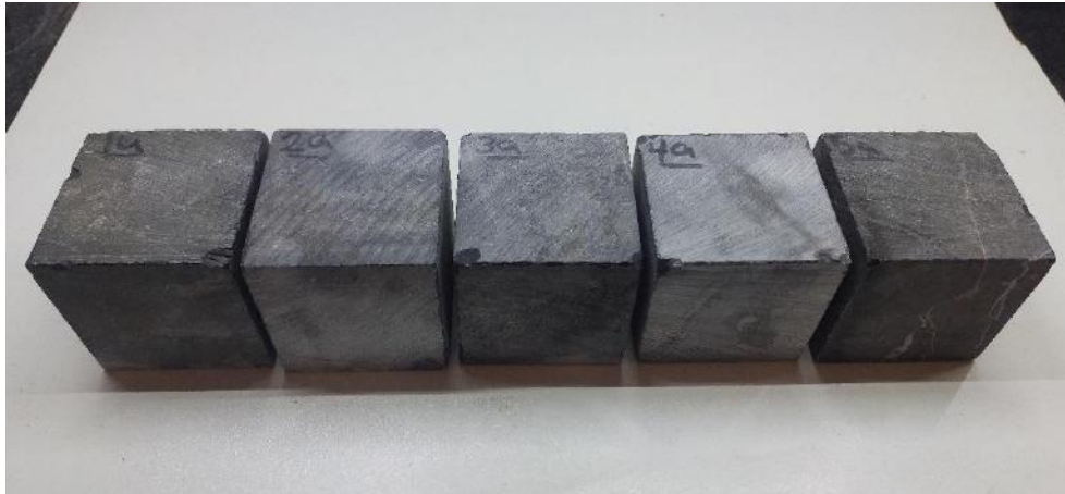
شکل ۱۲ تغییر در ظاهر نمونه پس از آزمایش در محلول اسید سولفوریک پس از ۲۰ چرخه
