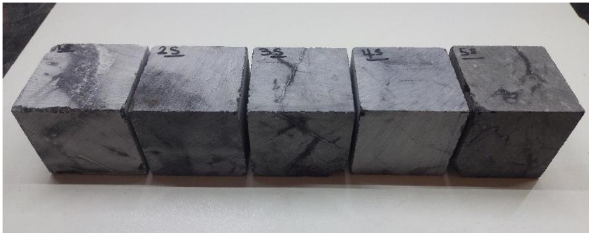
شکل ۹ تغییر در ظاهر نمونه پس از آزمایش تبلور نمک بعد از ۲۰ چرخه
