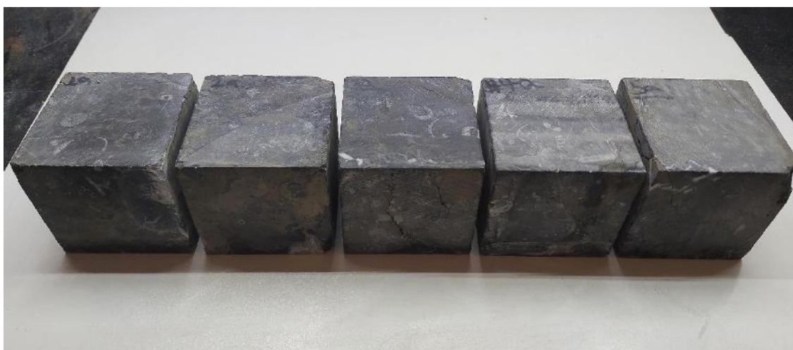
شکل ۱۲ تغییر در ظاهر نمونه پس از آزمایش در محلول اسید سولفوریک پس از ۲۰ چرخه
