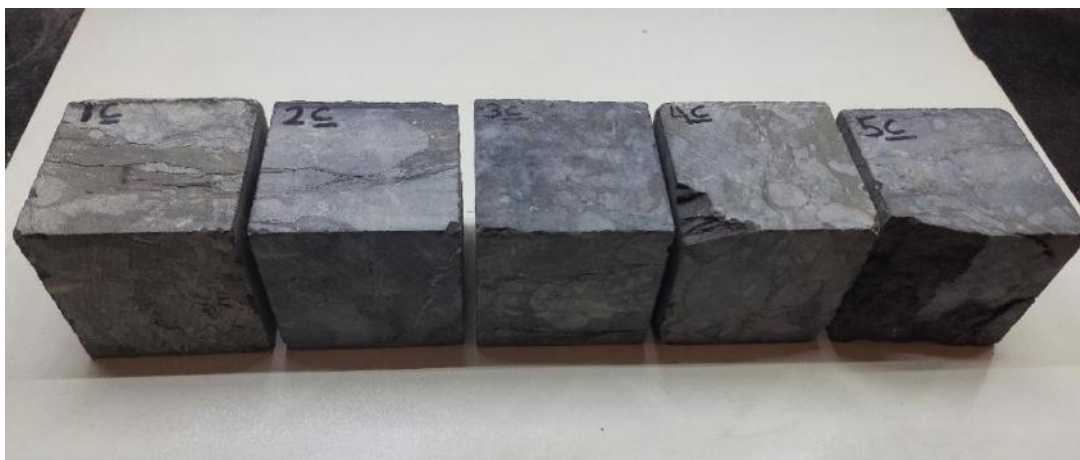
شکل ۱۴ تغییر در ظاهر نمونه پس از آزمایش در فرایندهای ترکیبی پس از ۲۰ چرخه
