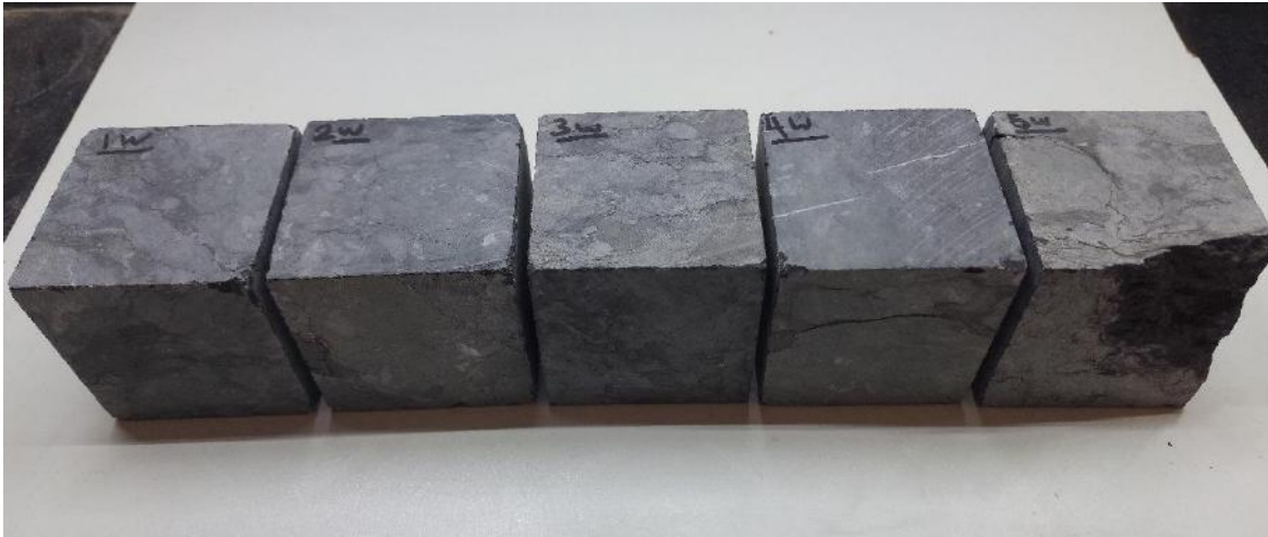
شکل ۱۱ تغییر در ظاهر نمونه پس از آزمایش تر-خشک شدن پس از ۲۰ چرخه
