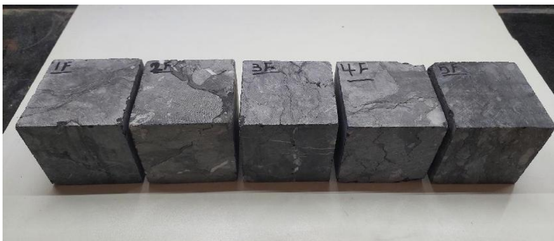
شکل ۱۰ تغییر در ظاهر نمونه پس از آزمایش انجماد- آب شدن پس از ۲۰ چرخه
